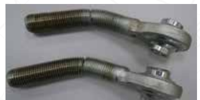
» Zkouška ohybem vřetena horního táhla až do úhlu ohybu cca 30°
